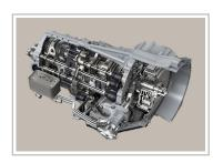
Das 7DTSportgetriebe überträgt Drehmomente bis 780 Nm.
