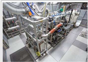
Wasserstoffmotor bei Mahle auf dem Prüfstand.
