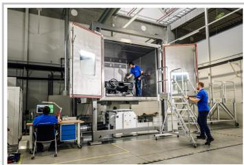
Im dreiachsigen Vibrations-Shaker wird die Belastbarkeit von Cockpits geprüft.
