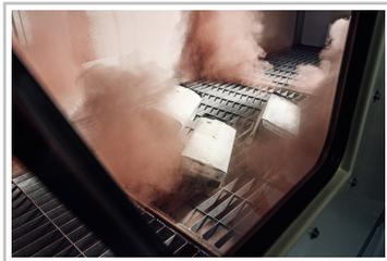
Staubtest von Airbag-Modulen mit sehr feinem Arizona-Wüstenstaub.
