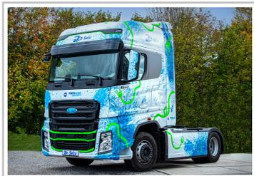
Prototyp eines schweren Brennstoffzellen-Lkw der RWTH Aachen auf Basis eines Ford F-Max im Rahmen des Forschungsprojekts „SeLv“.
