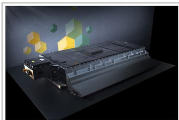
Batterie-Stack des Mercedes-Benz e-Sprinter.
