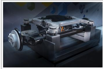
Elektrische Hinterachse des Mercedes-Benz e-Sprinter.
