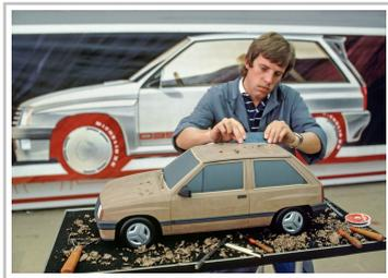
Entwicklungsarbeit am Opel Corsa A.
