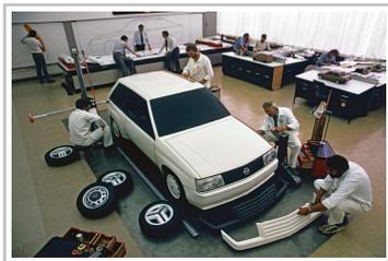
Entwicklungsarbeit am Opel Corsa A.
