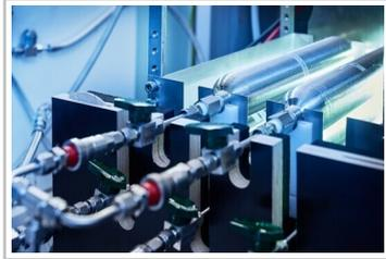
Wasserstoff-Speichertank mit Metallhydriden.
