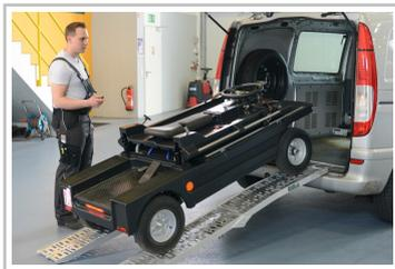
Carit Hop On mit zusammengeklapptem Fahrerstand.
