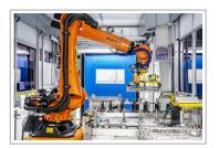
Skoda setzt bei der Getriebefertigung im Komponentenwerk Vrchlabí Smart-Handling-Roboter ein.
