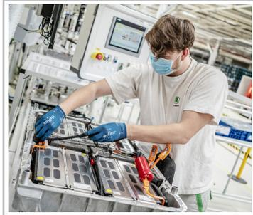
Batterieproduktion bei Skoda für Plug-in-Hybride.
