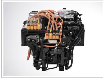
Brennstoffzelleneinheit des Toyota Mirai.
