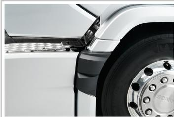
Scania-Seitenerkennung: Radar für den Abbiegeassistenten im Kotflügel der Beifahrerseite.
