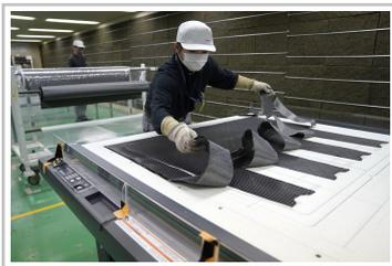
Herstellung von Carbonfaser-Komponenten bei Nissan.
