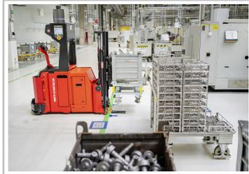
Automatisierte Teilebestellung und -lieferung der CNC-Bearbeitungslinien im Skoda-Komponentenwerk Vrchlabi.
