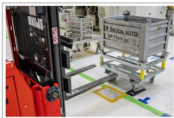
Automatisierte Teilebestellung und -lieferung der CNC-Bearbeitungslinien im Skoda-Komponentenwerk Vrchlabi. Die leeren Ladungsträger melden sich selbstständig.
