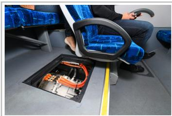
ZF-Versuchsträger mit dem elektrischen Zentralantrieb Cetrax.
