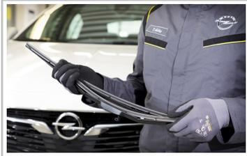
Scheibenwischerwechsel bei einem Opel-Händler.
