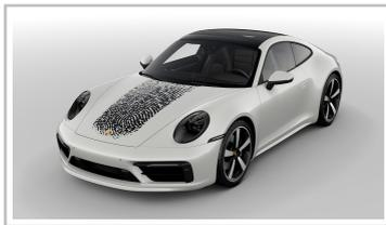
Direct-Printing: Porsche hat ein Verfahren entwickelt, mit dem grafische Elemente auf bereits lackierte Karosserieteile aufgetragen werden. Zunächst können Kunden eines 911 die Fronthaube mit dem eigenen Fingerabdruck bedrucken lassen.
