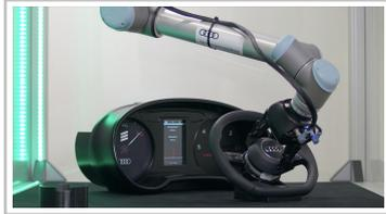
Ein mit 5G vernetzter industrieller Roboter baut ein Airbag-Modul in das Lenkrad eines Audi ein.
