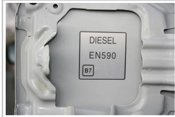
Künftig findet sich im Tankdeckel die offizielle Kraftstoffkennzeichnung, hier ein B7 in einem Quadrat für Diesel mit bis zu sieben Prozent Biodiesel. Bei Benzin ist die Kennung E5 oder E10 schwarz eingekreist.
