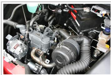
Zwei-Zylinder-Diesel von Kubota im Aixam.
