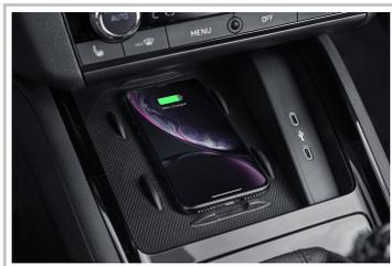
Skoda Scala und Kamiq können auf Wunsch mit Wireless Smartlink sowie einer induktiven Ladeschale mit Antennenanschluss für besseren Empfang ausgestattet werden.
