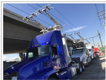
Oberleitungs-Trucks für die E-Highway-Teststrecke in Kalifornien.
