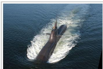
Unterseeboot U-32: Die modernen deutschen U-Boote fahren mit Strom aus Brennstoffzellen.
