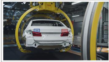
Symbolische Darstellung der Modellschriftzugererkennung durch die KI-Kamera in der Montage des BMW-Werks Dingolfing.
