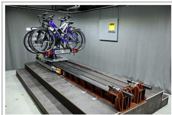
Der Fahrradträger SR3 plus von Bullwing (Testverlierer) zum Crashtest auf der ADAC Katapult-Anlage.
