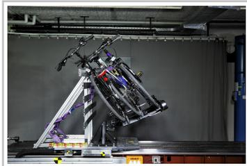
Crash-Simulation: Ein Fahrradträger mit Rädern in der ADAC Katapult-Anlage.
