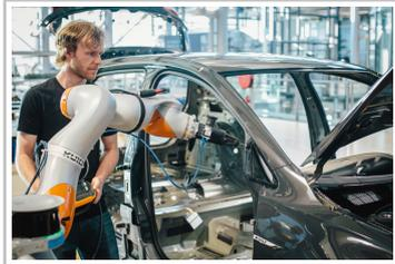
Software Development Center von Volkswagen in Dresden: Ein Roboter trägt den Primer für die Verklebung der Seitenscheibe auf, anschließend führt ein Kamerasystem die optische Qualitätskontrolle durch.
