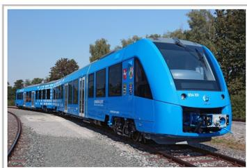
Brennstoffzellen-Zug Alstom Coradia i-Lint.
