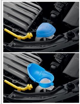
Neue Simply-Clever-Idee von Skoda: Der Verschlussdeckel des Scheibenwaschbehälters stülpt sich beim Öffnen automatisch zum Trichter um.
