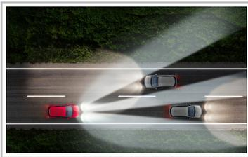
Opel Intellilux LED Matrix-Scheinwerfer: maximales Licht ohne Blendung.
