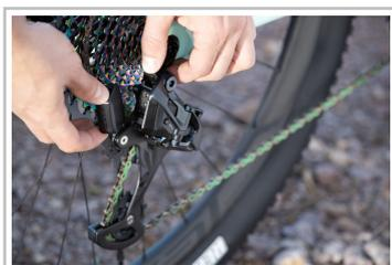
Entnehmbarer der Fahrrad-Funkschaltung Eagle AXS von Sram.
