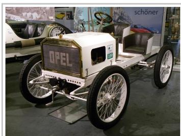
Opel Classic: Opel-Rennwagen von 1903 mit Zwei-Zylinder-Motor, 1885 ccm, 12 PS, etwa 70 km/h.
