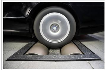
Test auf dem Rollenprüfstand.
