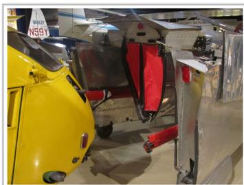
Aerocar I: Die Anschlüsse für die Tragflächen und die Kupplung für die Druckschraube am Schwanzende.
