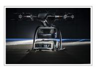
Das Flugtaxi-Konzept "Pop.Up Next" kombiniert ein selbstfahrendes Elektroauto mit einer Passagierdrohne (funktionsfähiges Modell im Maßstab 1:4).
