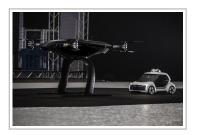
Das Flugtaxi-Konzept "Pop.Up Next" kombiniert ein selbstfahrendes Elektroauto mit einer Passagierdrohne (funktionsfähiges Modell im Maßstab 1:4).
