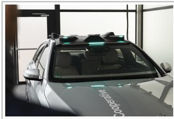
Mercedes-Benz S-Klasse mit 360-Grad-Lichtsignalisation für autonome Fahrten.
