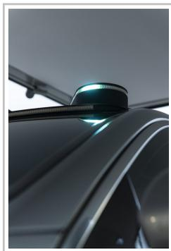
Mercedes-Benz S-Klasse mit 360-Grad-Lichtsignalisation für autonome Fahrten.
