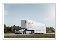
Autonome und elektrisch angetriebene Sattelzugmaschine von Volvo.
