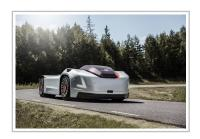
Autonome und elektrisch angetriebene Sattelzugmaschine von Volvo.
