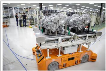
Produktion von Hybridgetrieben im polnischen Toyota-Werk Walbrzych.
