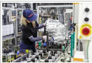
Produktion von Hybridgetrieben im polnischen Toyota-Werk Walbrzych.
