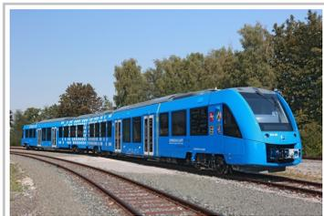
Brennstoffzellen-Zug Alstom Coradia i-Lint.
