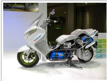
Tokio 2011: Brennstoffzellen-Roller von Suzuki.
