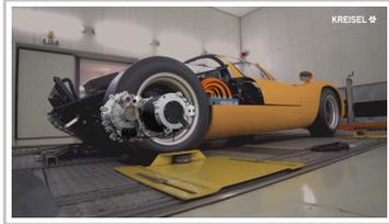
Kreisel Sala Zwei-Gang-Getriebe für Elektromotoren.
