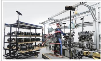
Pilotversuch Body Tracking in der Fertigung bei Ford.
