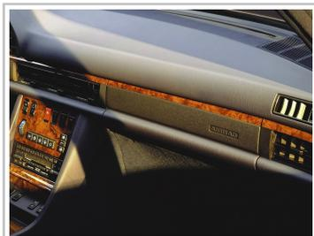
Beifahrerairbag mit Kennzeichnung auf der Verkleidung der Armaturentafel im Mercedes-Benz S-Klasse der Baureihe 126.
