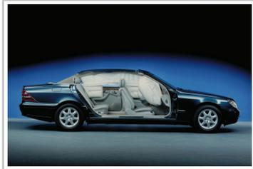
Die Mercedes-Benz S-Klasse der Baureihe 220 ist bei ihrer Premiere 1998 serienmäßig mit acht Airbags ausgestattet: zwei Frontairbags für Fahrer und Beifahrer, insgesamt vier Sidebags vorn und im Fond sowie der neu entwickelte Windowbag auf beiden Seiten.
