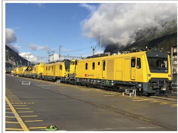
Vier Basisfahrzeuge der SBB mit Modultragwagen im Zugverbund für die Wartung des Gotthard-Basistunnels.
