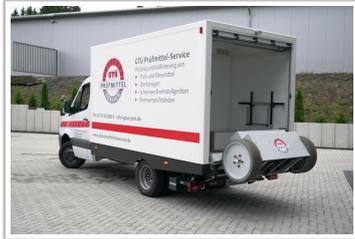
Mobiler Bremsenprüfstand für Werkstätten.
