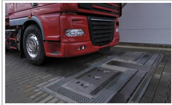
Automatisiertes Reifenkontrollsystem von Ventech Systems.
