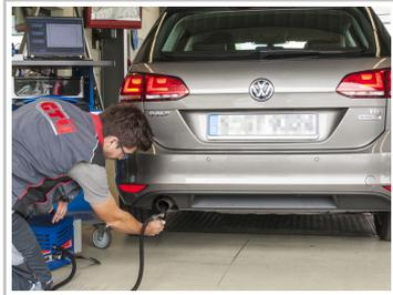
GTÜ-Prüfingenieur bei der Abgasmessung am Endrohr.
