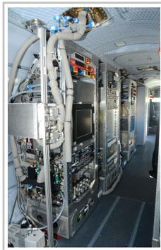
Messapparatur an Bord der Halo-Gulfstream der DLR.
