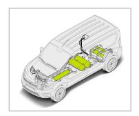
"Natural Power"-Modell mit Erdgasmotor: System der Anlage im Fiat Nuovo Doblò.
