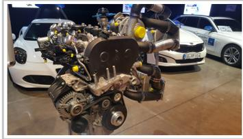
Von AVL modifizierter 1750er-Motor von Alfa Romeo, der eine Literleistung von 200 kW / 272 PS überschreitet
