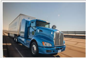
Konzeptfahrzeug: Kenworth Glider mit Brennstoffzellenantrieb von Toyota.
