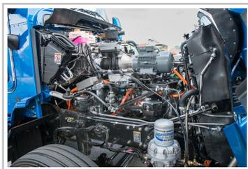
Konzeptfahrzeug: Kenworth Glider mit Brennstoffzellenantrieb von Toyota.
